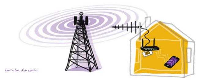
Riktantenn monterad på huset tar emot mobilsignalen från basstationen. Via en antennkabel ansluts en bredbandsrouter med mobilanslutning (router med SIM-kort) och inomhus genereras ett trådlöst wifi-nät.
